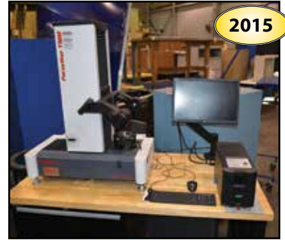
2015 PARLEC Parsetter TMM Tool Pre-Setter
