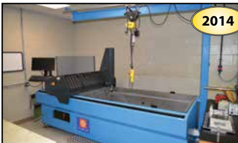
2014 TIEVAL MIDAS-NDT M403T Fan Blade Scanner
