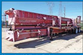
Schramm Load Safe Pipe Handling System
